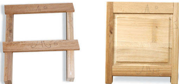
Côté du coffre. Pièces établies après corroyage, puis côté terminé.
