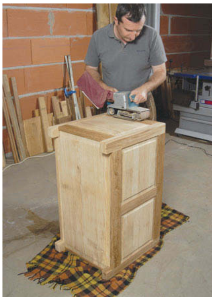
Vieille couverture protégeant la partie du coffre placée contre le sol.
