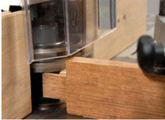
Usinage par-dessus.
