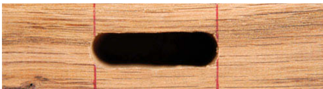
Mortaise respectant le tracé. L'assemblage sera solide.
