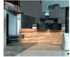
Exécution d'un enfourchement.
