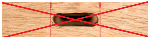
Mortaise incorrecte : l'assemblage sera impossible.
