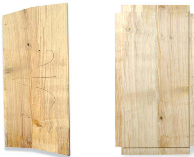
Fond du coffre. Pièces établies après corroyage, puis fond terminé.
