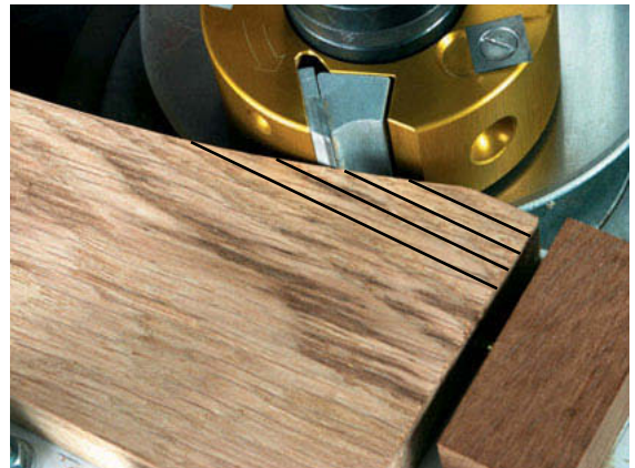
Usinage à contre-fil.
