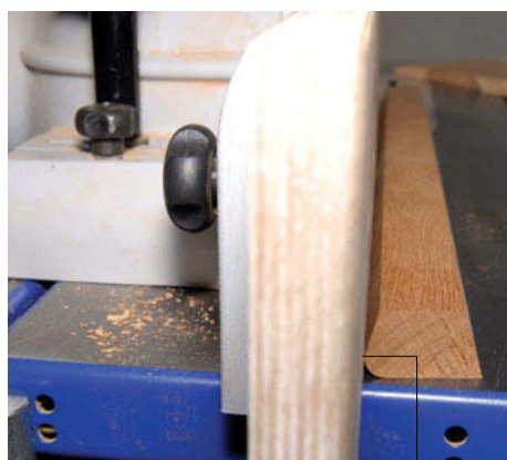
contact entre la pièce et le guide de sortie
